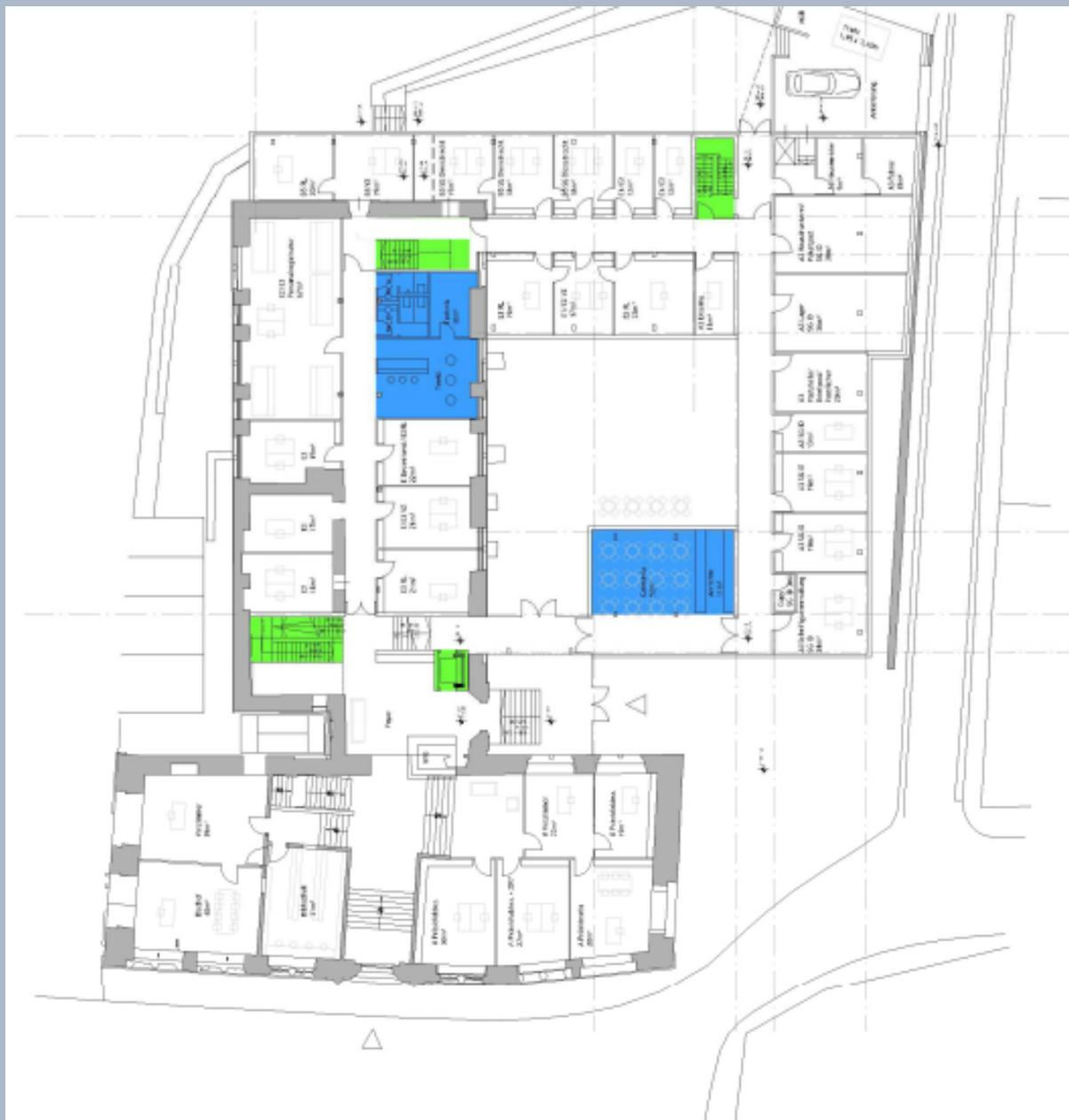
Die Erschließung im Haus führt pro Etage mit Höhenversprüngen einmal rundherum. Drei Treppenhäuser führen in die einzelnen Etagen.
